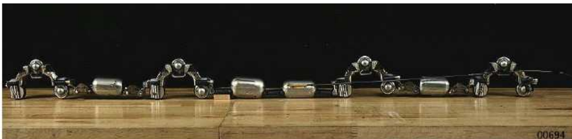
Figura 9 – Sistema robotizzato per la posa dei cavi -
